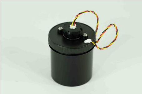
Die fertige Trübungsdose wird später mit dem gelb/schwarz/roten Kabel an die Sensorbox angeschlossen.
